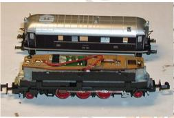
de circuito impreso mediante los tornillos de sujeccción a la placa. Además se aprecia ya el conector NEM 651, en principio Estandard, pero ya veremos posteriormente que con algúna pega.
